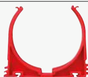
Rohrschelle, DN75; zur Befestigung alle 1,5 bis 2,0 m entlang des Rohrs sowie vor und nach jeder Biegung zu montieren
